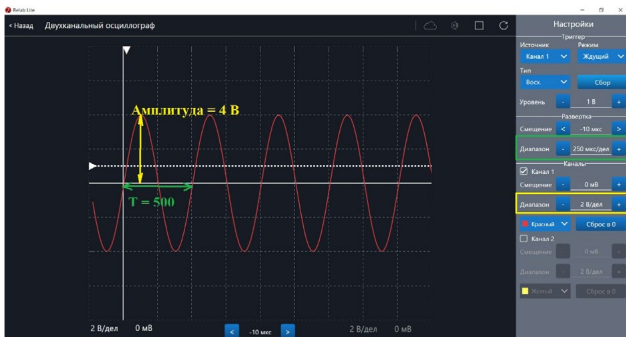
Рис. 42. Определение параметров осциллограммы
